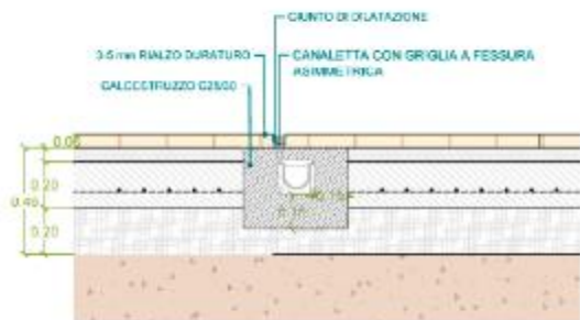
CANALETTA A FESSURA- POSA scala 1:20
