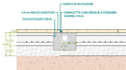
CANALETTA A FESSURA- POSA scala 1:20
